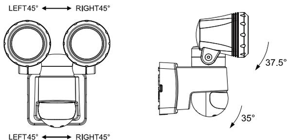
Der Lichtaustrittswinkel der LED Köpfe kann durch drehen an den Ringen der Lampenkappen um die LEDs angepasst werden.
