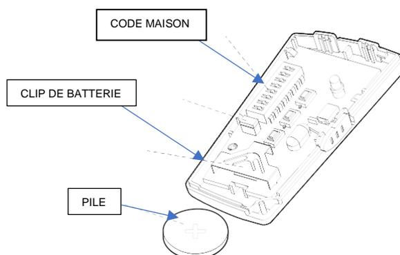
Insérez la pile (3V, CR2032). Vérifiez le code maison de votre système et insérez-le dans la télécommande (même procédure que celle des capteurs porte/fenêtre et du PIR). Avant d'ouvrir un capteur porte/fenêtre ou un PIR, entrez le mode installation avec le panneau d'alarme :
