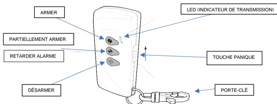
La télécommande incorpore une TOUCHE D'ATTAQUE PERSONELLE (panique). Activer une alarme panique va immédiatement initier une alarme complète peu importe que le système soit armé ou désarmé (à moins que le système n'est pas dans les modes entretien, test ou programmation).
