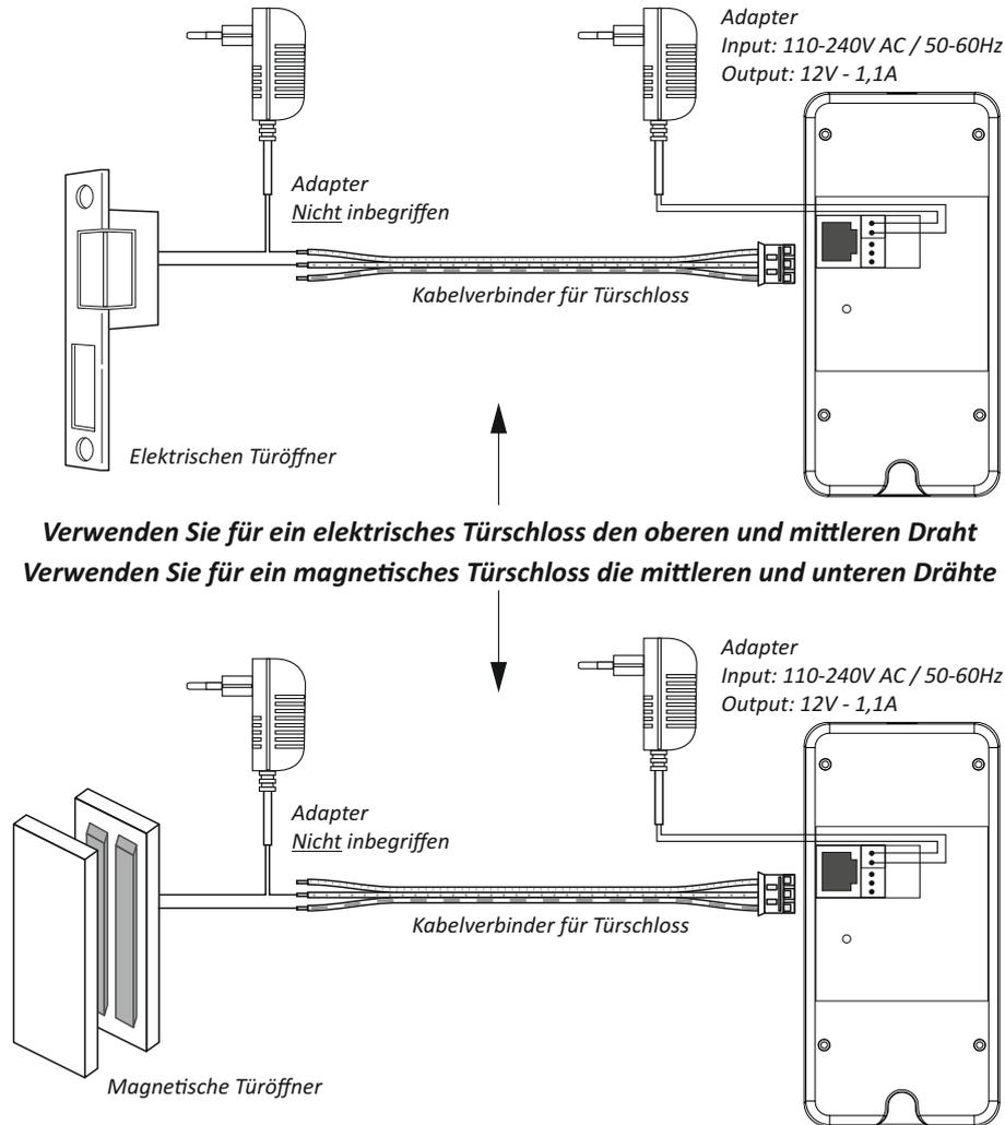
**Verwenden Sie für ein elektrisches Türschloss den oberen und mittleren Draht**
